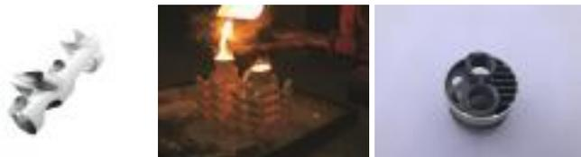
**Schwerpunkte** Feingussteile in Stahlwerkstoffen
