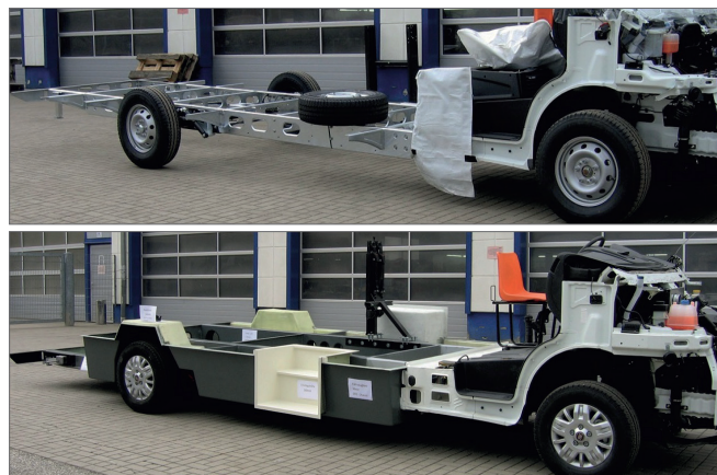
Konventioneller Gitterrohrrahmen und FVK Bodengruppe
