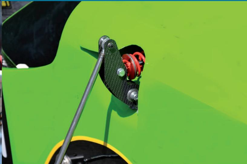
Mischverbindung aus faserverstärkten Kunststoff und Metall im Fahrzeugbau
