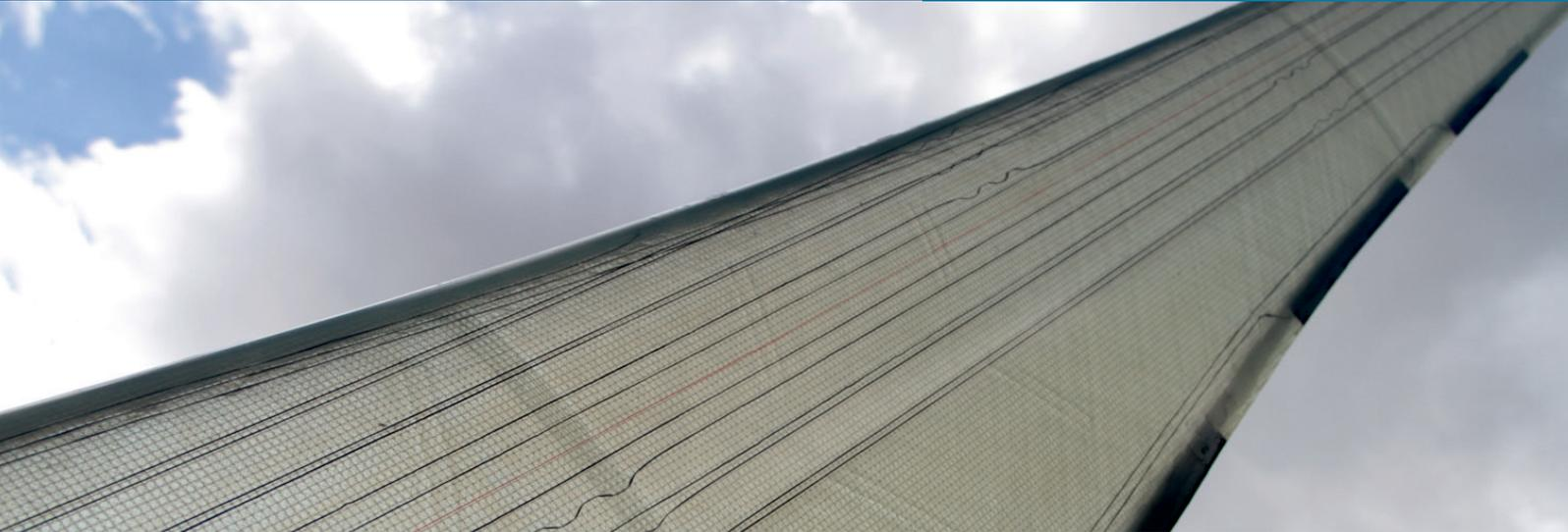
Rotorblatt einer Kleinwindenergieanlage mit anforderungsgerechter, integrierter und textilbasierter Sensorik
