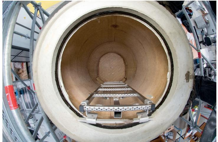
Tragwerks-Rehabilitation durch medienbeständige Faserverbund-Sandwichstrukturen
