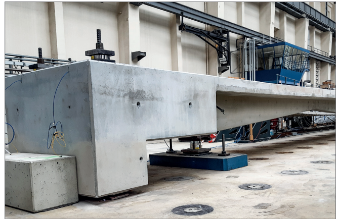
Prototyp einer Carbonbetonbrücke mit vorgespannten CFK-Litzen
