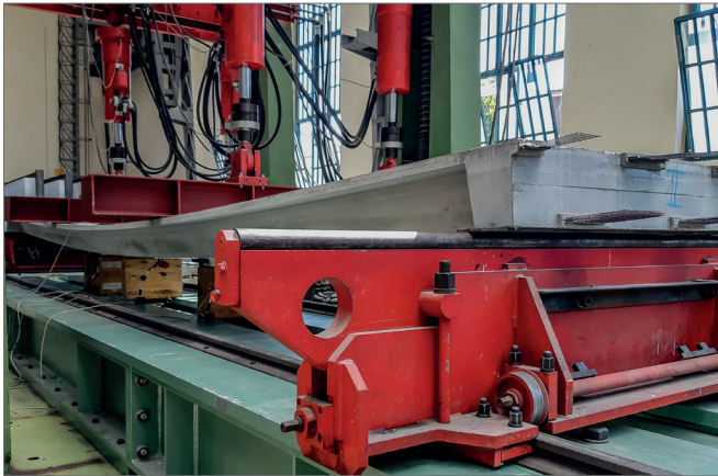
Trapezfaltwerk aus vorgespanntem Carbonbeton im 4-Punkt-Biegeversuch
