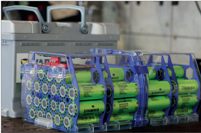
70 Ah Blei neben 140 Ah Leichtbau-Starterbatterie
